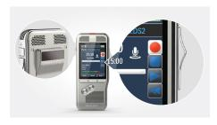
Commande par interrupteur à curseur (enregistrement, arrêt, lecture, retour rapide) Scanner de code-barre intégré
